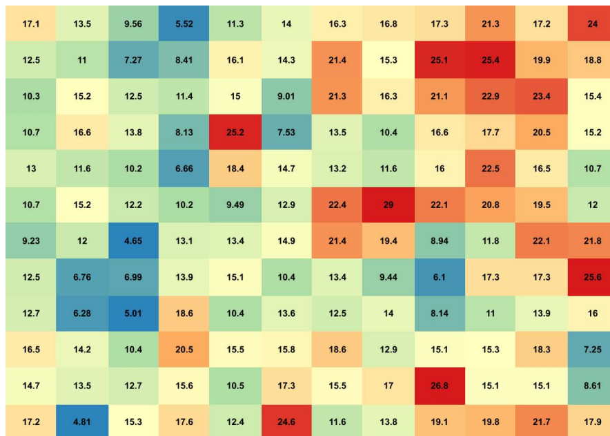
Rys. 2. Rozkład porowatości piaskowca po podziale na 144 prostokąty
