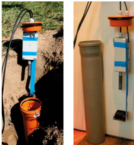
Rys. 6. Fotografia sondy pomiarowej i zabudowy sondy Źródło: Tarkowski i zespół 2009–2015
