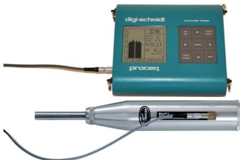
Rys. 21. Cyfrowy młotek Schmidta typu DIGI (firma Proceq)
