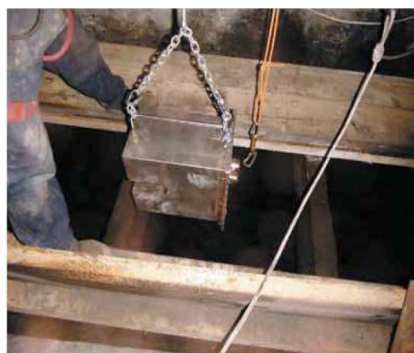
Rys. 8. Skaner laserowy 2D przygotowany do pracy w zbiorniku retencyjnym (Bock i in. 2016)
