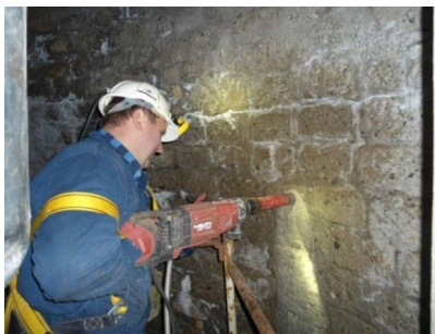
Rys. 24. Pobieranie próbki materiału obudowy szybowej
