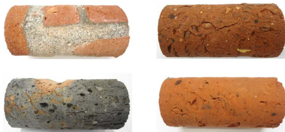
Rys. 25. Widok próbek pobranych z obudowy murowej szybu
