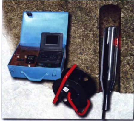
Rys. 27. Ogólny widok kamery introskopowej
