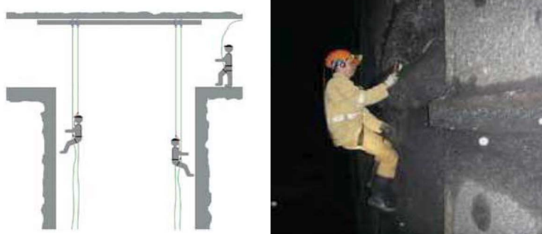
Rys. 6. Uproszczony schemat badań metodą „alpinistyczną” (Bock. i in. 2016)
