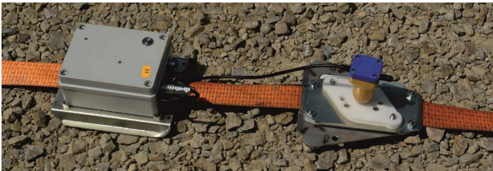
Rys. 2. Widok zestawu pomiarowego systemu Seismobile. Po lewej stronie moduł pomiarowy, natomiast po prawej połączony z nim krótkim kablem geofon, mocowane na metalowej podstawie (Kubańska i in. 2016)
