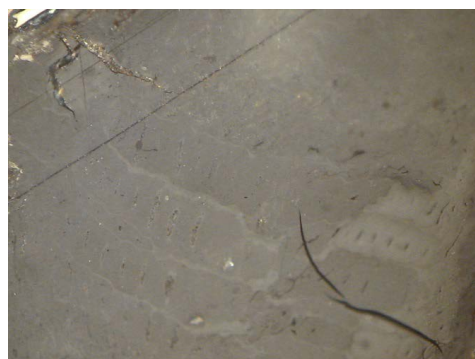
Rys. 3. Telinit, światło białe odbite, pow. 500x w immersji olejowej
