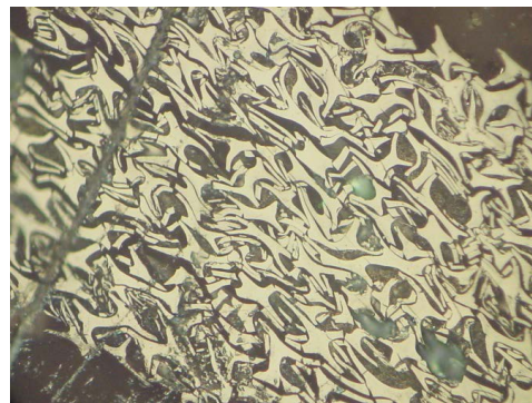
Rys. 7. Fuzynit, światło białe odbite, pow. 500x w immersji olejowej
