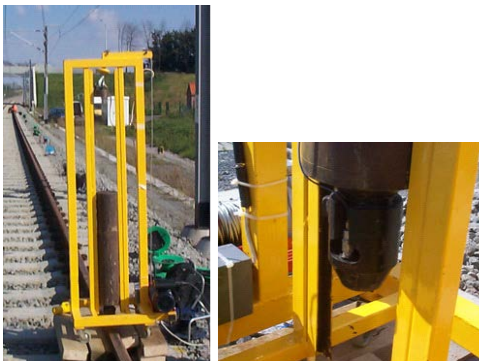
Fot. 1. Spadająca masa służąca do wymuszeń impulsowych o ciężarze odpowiadającym ciężarowi sondy DSPH (63,5 kg) z widocznym niskoczułym akcelerometrem
