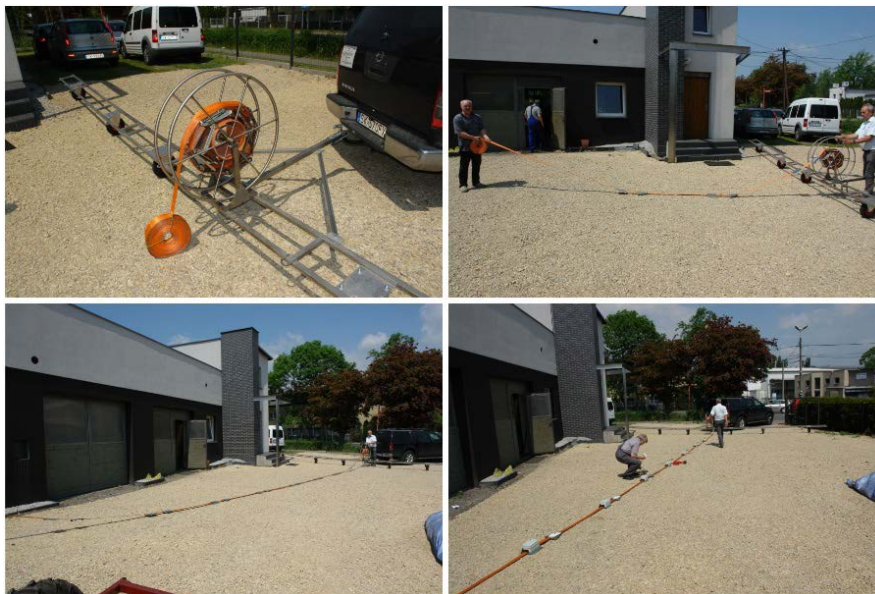
Fot. 2. Przykładowy montaż linii pomiarowej: rozwijanie taśmy z bębna transportowego z zestawami pomiarowymi
