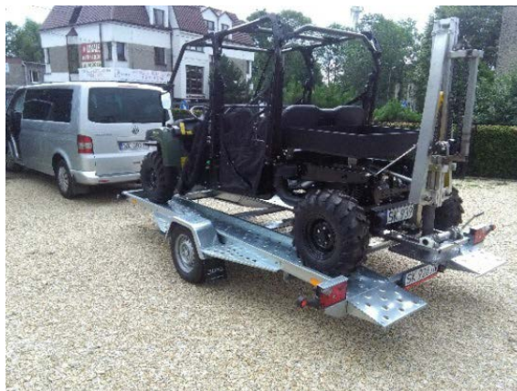
Fot. 6. Mobilny wzbudnik strimera Seismobile podczas transportu
