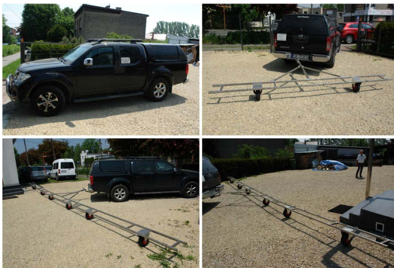
Fot. 1. Widok samochodu terenowego z ramą do holowania w wariantach 2 i 4 linii pomiarowych
