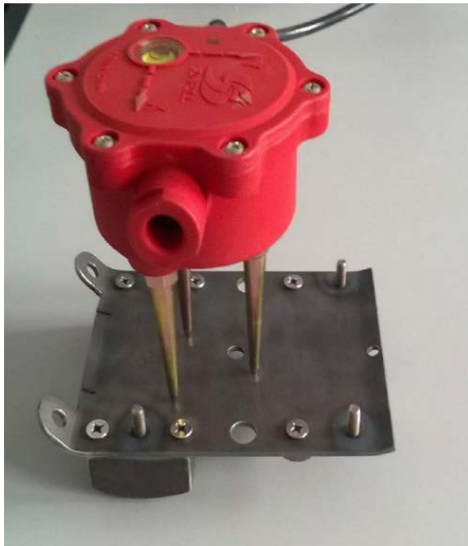
Fot. 1. Przykład testowanej podstawy wraz z geofonem w pozycji pomiarowej
