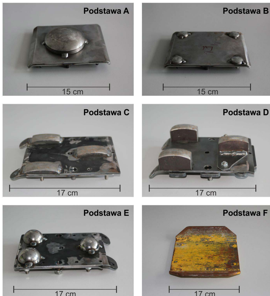
Rys. 1. Rodzaje testowanych podstaw geofonów
