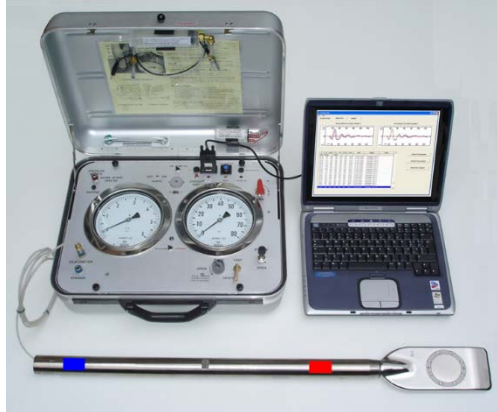
Rys. 6. Wyposażenie dylatometru sejsmicznego (Marchetti i in. 2008b)
