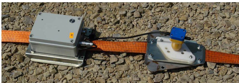
Fot. 1. Zestaw pomiarowy strimera sejsmicznego składający się z geofonu mocowanego na metalowej podstawie z trzema „nózkami” w kształcie półkul oraz współpracującego z modulem pomiarowym mocowanym na innej metalowej podstawie z wyprofilowanymi płozami
