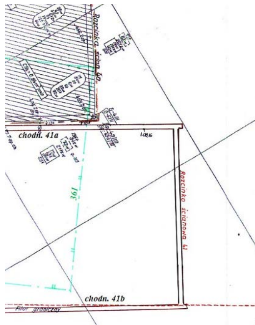
Rys. 17. Wycinek mapy pokładu 357+358 z zaznaczoną rozcinką ścianową 41
